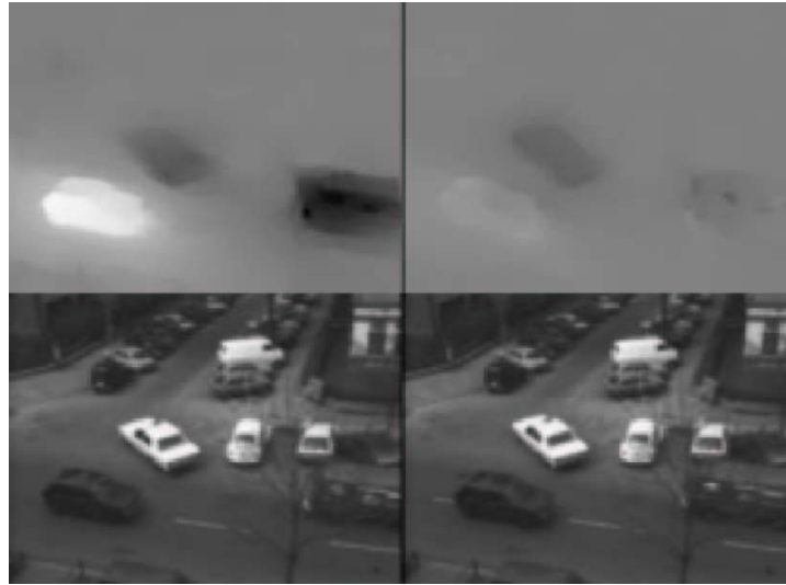
Figura 7. En la parte inferior observamos 2 frames de una secuencia video. En la parte superior representamos las dos componentes del desplazamiento encontrado. El nivel de gris medio indica desplazamiento 0. Un tono claro indica desplazamiento en dirección positiva, y un tono oscuro desplazamiento en dirección negativa.
